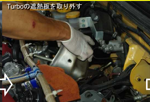
TurboとSPORTS CATALYZERを切り離す
