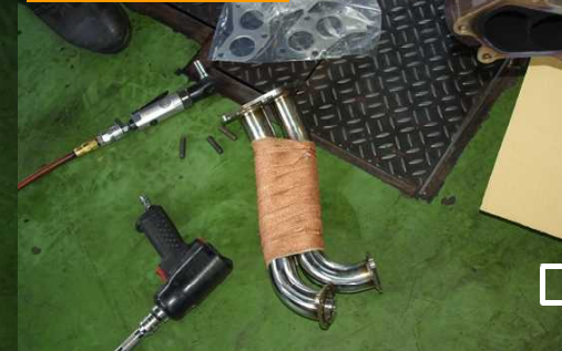
ラジエーターローアース等に、付属のフレックスヒートシールドを装着した
