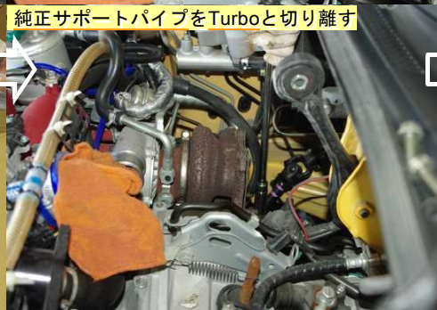
純正サポートパイプとEXマニホールドを切り離す
