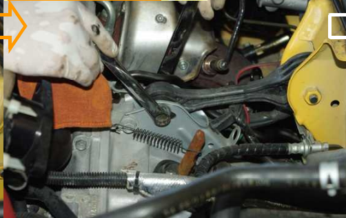
SPORTS CATALYZERを装着 ピッチングストッパーを固定
