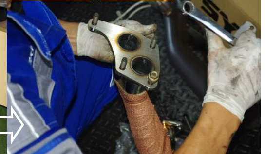
ラジエーターローアース等に、付属のフレックスヒートシールドを装着した
