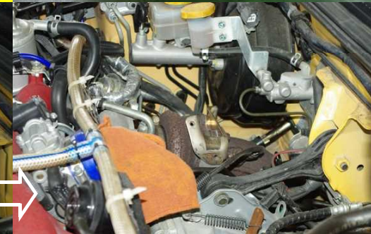
ピッチングストッパーのエンジン側を切り離す
