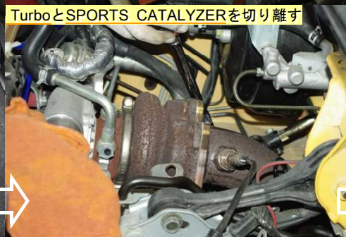
純正サポートパイプをTurboと切り離す
