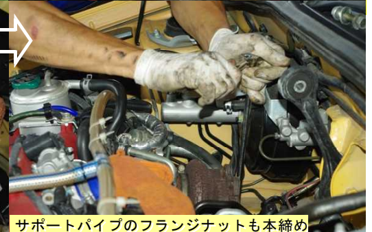
サポートパイプのフランジナットも本締め
