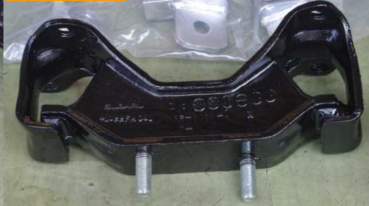
外側の2個が取り外したノーマルエンジンマウント、内側2個がキットを組み込んだSTI純正強化マウント
