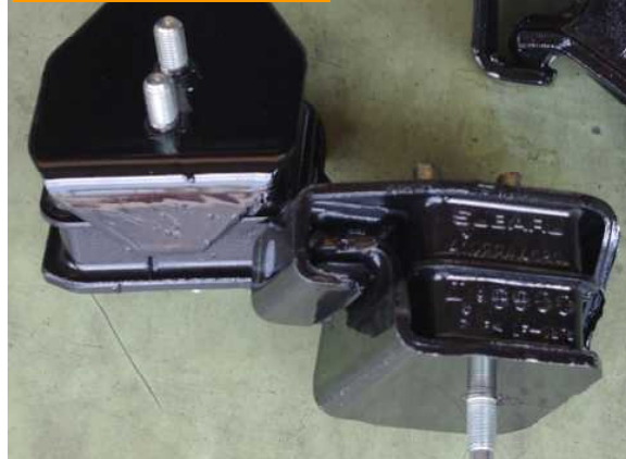
外側の2個が取り外したノーマルエンジンマウント、内側2個がキットを組み込んだSTI純正強化マウント
