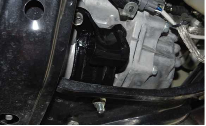
装着したT/Mマウントは、下側に5mm厚のワッシャーを咬ませて…
