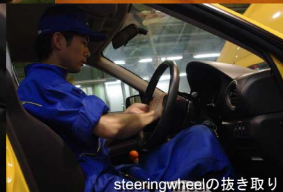
慎重に6本のβTITANIUM製steering vtsを締め込んでいく。
