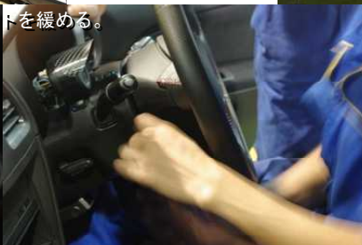
正確に指定通り3kg/mのトルクでadapterを締め込む。
