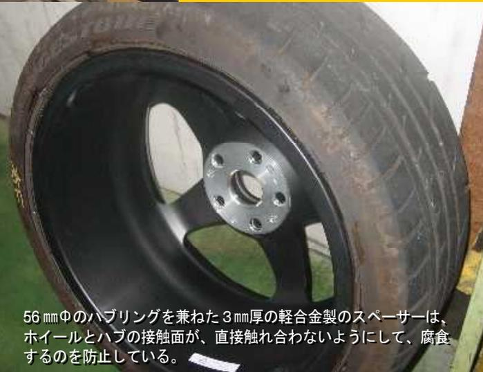
56mm 中のハブリングを兼ねた 3mm 厚の軽合金製のスペーサーは、ホイールとハブの接触面が、直接触れ合わないようになっているので、腐食するのを防止している。
